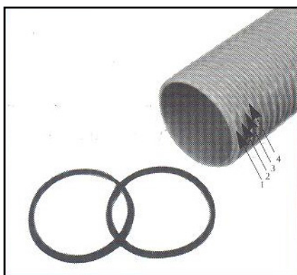
Fig. 5 Ønsker man at anvende ultra rør SKAL indlæg monteres som følgende inden overgangen monteres.
