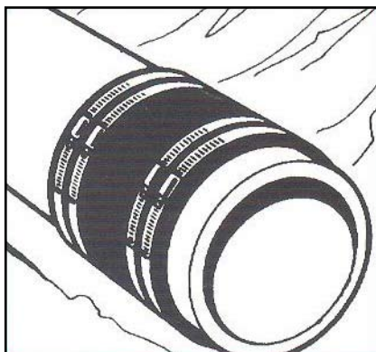
Fig. 2 Spændebåndene løsnes og overgangen monteres på rørenden.
