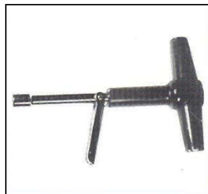
Fig. 6 Bespænding kan foretages med Fernco momentnøgle 7 Nm.
